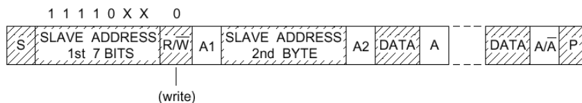
图 26 主机一发送器用 10 位地址寻址从机一接收器
