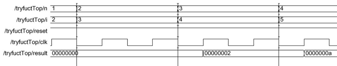
练习: 设计一个带控制端的逻辑运算电路, 分别完成正整数的平方、立方和阶乘的运算。编写测试模块, 并给出仿真波形。
