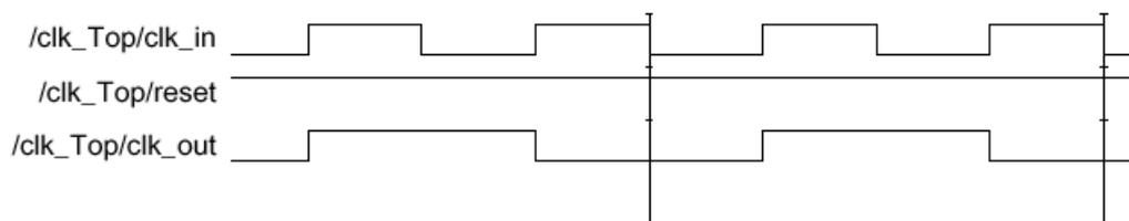
练习：依然作 clk\_in 的二分频 clk\_out，要求输出与上例的输出正好反相。编写测试模块，给出仿真波形。
