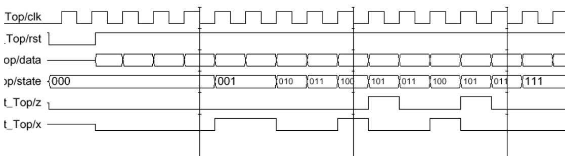
练习: 设计一个串行数据检测器。要求是: 连续 4 个或 4 个以上的 1 时输出为 1, 其他输入情况下为 0。编写测试模块并给出仿真波形。
