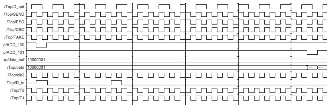
练习：设计一个序列发生器。要求根据输入的 8 位并行数据输出串行数据, 如果输入数据在 0—127 之间则输出一位 0, 如果输入数据在 128—255 之间则输出一位 1, 同步时钟触发; 并且和范例 8 的序列检测器搭接, 形成一个封闭系统。编写测试模块, 并给出仿真波形。
