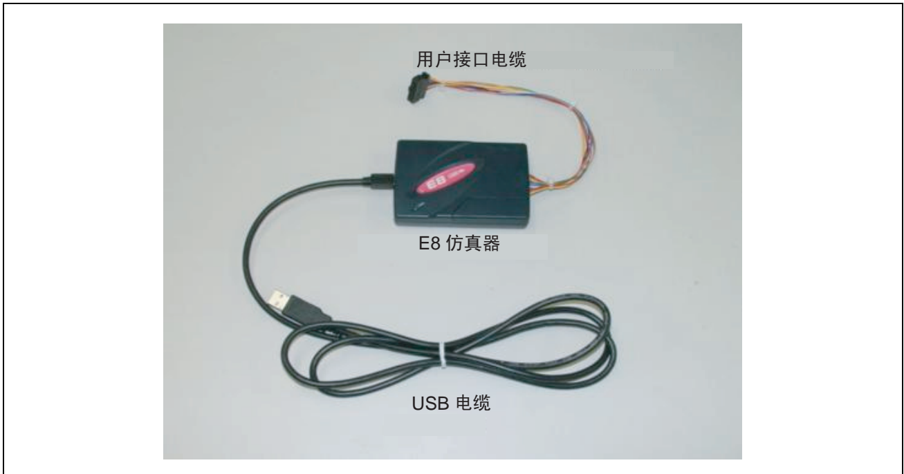
图 3.2 E8 仿真器的硬件构成
