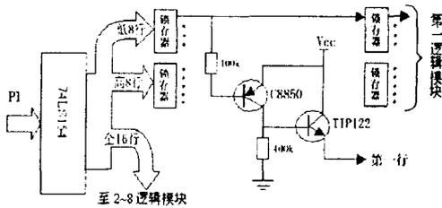
图3 行驱动电路工作原理
