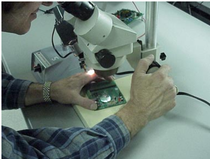
图 35. 立体变焦检查台（7X 到 40X 放大） 帮助检查焊接质量
