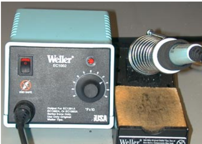
图 4. 带细烙铁头的 ESD 保护焊台 这是一个 Weller EC1201A 型焊台
