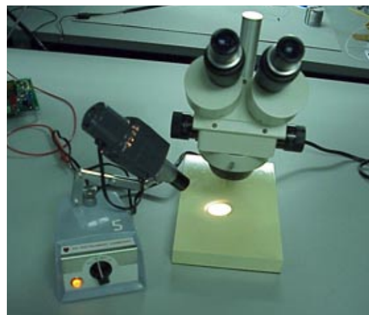
图 5. 可选设备，包括一个 PCB 钳和 一个 7-40X 检查显微镜
