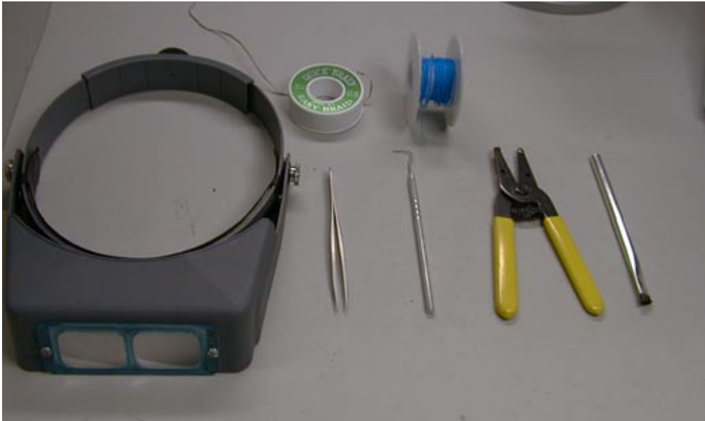
图 2. 从左开始顺时针方向：4X 头戴式放大镜、吸锡带、 卷装导线、硬清洁刷、剥线钳和尖镊子
