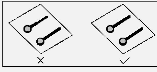
同一网络的布线宽度应保持一致, 线宽的变化会造成线路特性阻抗的不均匀, 当传输的速度较高时会产生反射, 在设计中应该尽量避免这种情况。在某些条件下, 如接插件引出线, BGA封装的引出线类似的结构时, 可能无法避免线宽的变化, 应该尽量减少中间不一致部分的有效长度。
