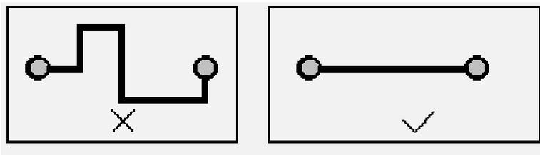
即短线规则，在设计时应该尽量让布线长度尽量短，以减少由于走线过长带来的干扰问题，特别是一些重要信号线，如时钟线，务必将其振荡器放在离器件很近的地方。对驱动多个器件的情况，应根据具体情况决定采用何种网络拓扑结构。
