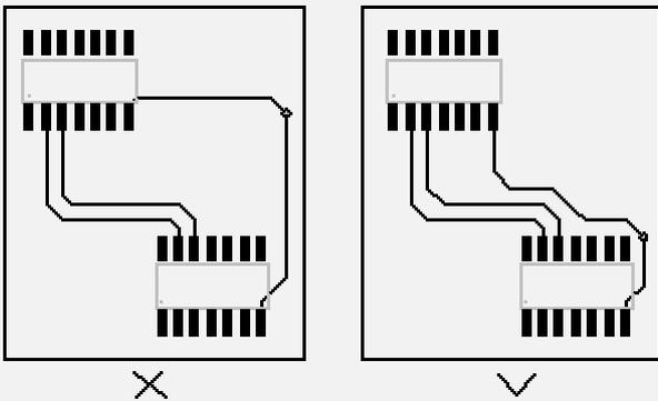
环路最小规则，即信号线与其回路构成的环面积要尽可能小，环面积越小，对外的辐射越少，接收外界的干扰也越小。针对这一规则，在地平面分割时，要考虑到地平面与重要信号走线的分布，防止由于地平面开槽等带来的问题；在双层板设计中，在为电源留下足够空间的情况下，应该将留下的部分用参考地填充，且增加一些必要的孔，将双面地信号有效连接起来，对一些关键信号尽量采用地线隔离，对一些频率较高的设计，需特别考虑其地平面信号回路问题，建议采用多层板为宜。
