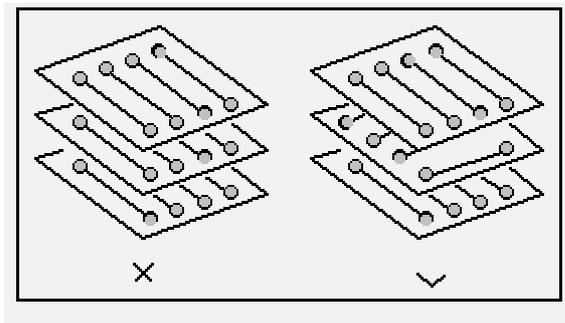
即相邻层的走线方向成正交结构。避免将不同的信号线在相邻层走成同一方向，以减少不必要的层间窜扰；当由于板结构限制（如某些背板）难以避免出现该情况，特别是信号速率较高时，应考虑用地平面隔离各布线层，用地信号线隔离各信号线。
