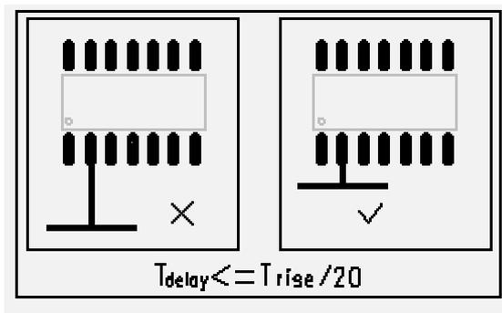
尽量控制分枝的长度，一般的要求是 $T_{delay} \leq T_{rise} / 20$ 。
