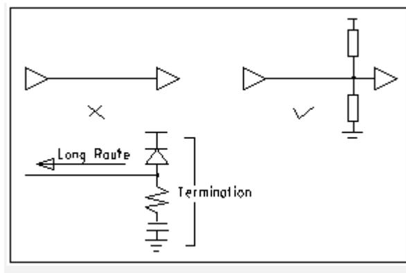
在高速数字电路中, 当PCB布线的延迟时间大于信号上升时间 (或下降时间) 的1/4时, 该布线即可以看成传输线, 为了保证信号的输入和输出阻抗与传输线的阻抗正确匹配, 可以采用多种形式的匹配方法, 所选择的匹配方法与网络的连接方式和布线的拓扑结构有关。
