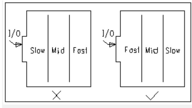
A. 主要是为了防止不同工作频率的模块之间的互相干扰，同时尽量缩短高频部分的布线长度。通常将高频的部分布设在接口部分以减少布线长度，当然，这样的布局仍然要考虑到低频信号可能受到的干扰。同时还要考虑到高/低频部分地平面的分割问题，通常采用将二者的地分割，再在接口处单点相接。
