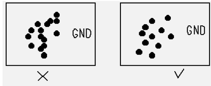
通常是将孤立铜区接地或删除。在实际的制作中, PCB厂家将一些板的空置部分增加了一些铜箔, 这主要是为了方便印制板加工, 同时对防止印制板翘曲也有一定的作用。
