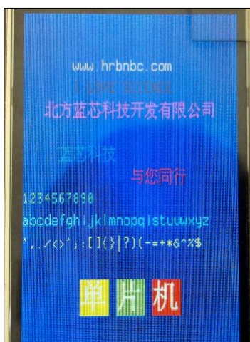
字符显示例程，字符显示包含了中英文，16x16 以及 32X32 点阵字符
