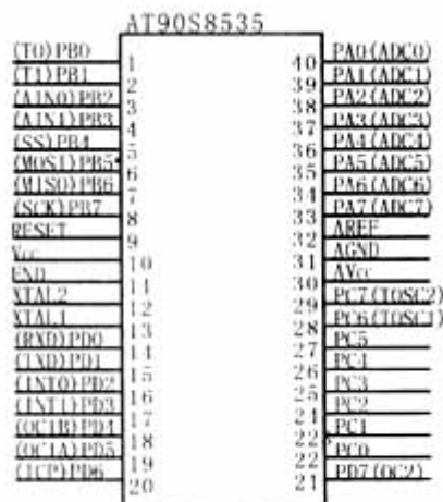
图 2 AT90S8535 单片机引脚图
