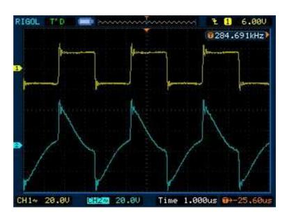
上管 G/S 对地波形: CH1-上管栅极 G CH2-上管输出 S 基准: 电源地 波形图:
