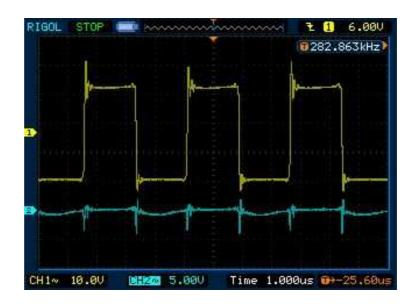
配置不变 ch1: 半桥输出端 ch2 测量 LC 串联处 测量基准对地: 波形:
