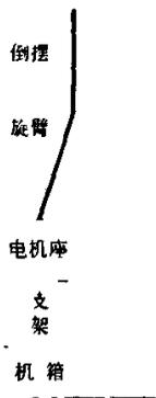
图 1-3 单级旋转式倒立摆系统构成
