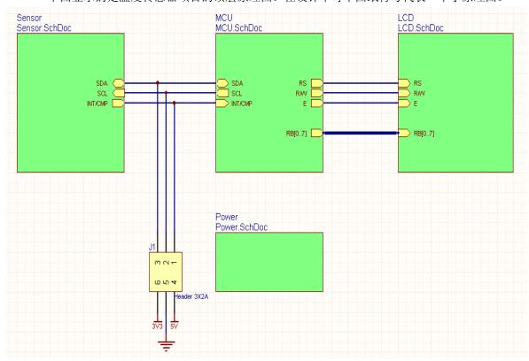
图 60.温度传感器的顶层原理图
