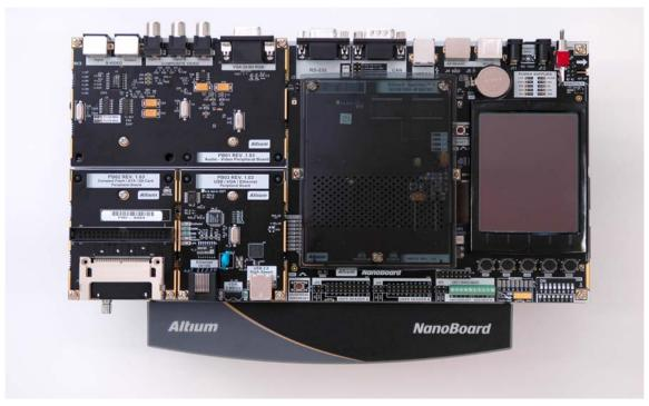
图 2 可重构的硬件验证平台 NanoBoard2
