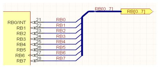
图 48: 用参考系统定义的总线
