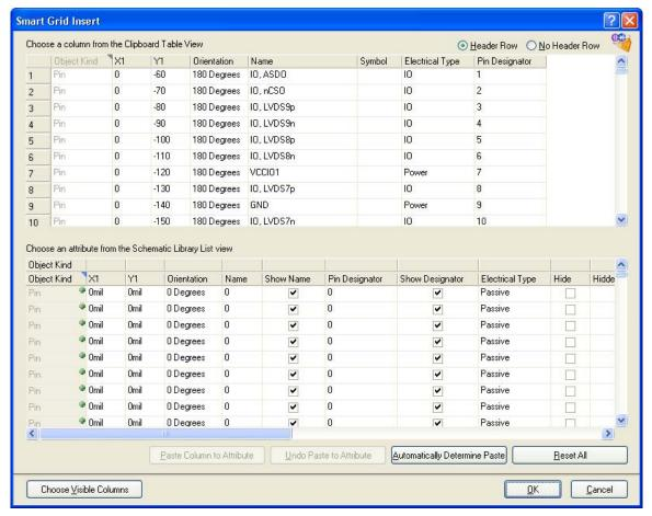
图 59.随粘贴出现的智能网格插入对话框
