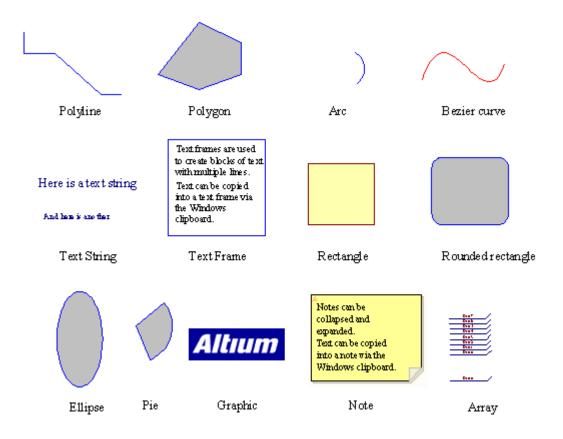
图 23. 原理图绘图对象
