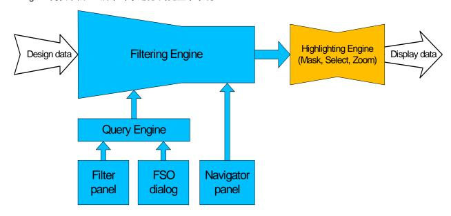
图 56 过滤/高亮系统图表
