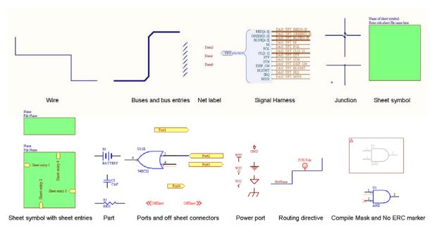
图 25 原理图电气连接工具
