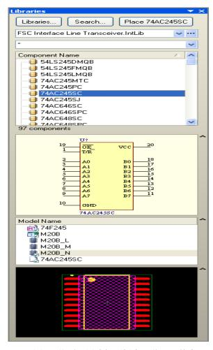
图 46 从原理图编辑面板中浏览元器件库
