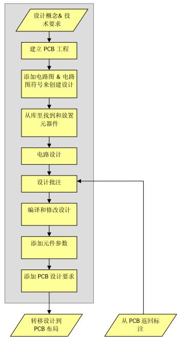
图 37 Altium Designer 原理图设计流程
