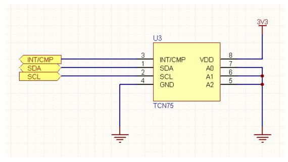
图 52: 连接好的传感器原理图
