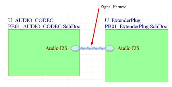
图 27. 一个 Signal Harness 可以携带导线,总线和其它的 signal harnesses 混合体.
