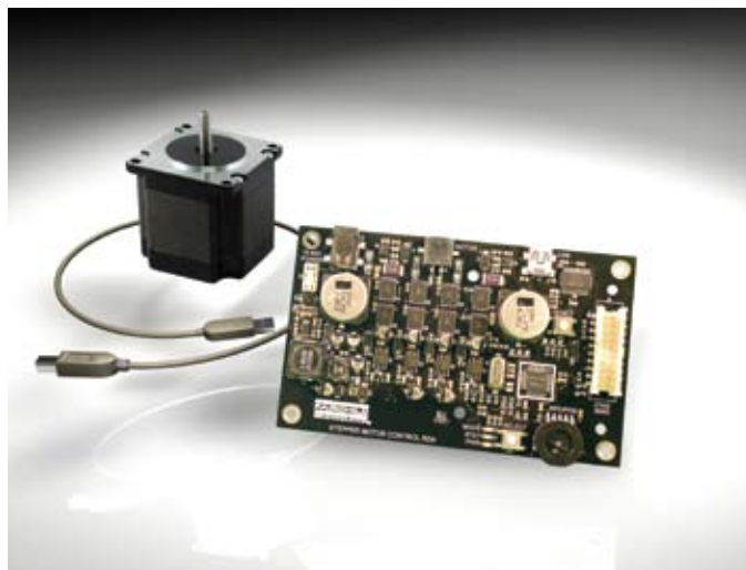
Stellaris 步进电机参考设计套件
