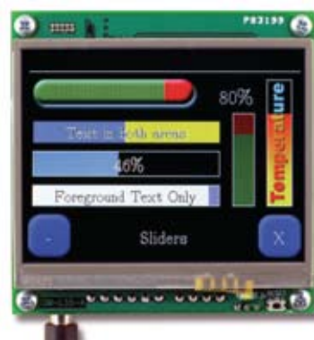
带 3.5 英寸横屏显示的 Stellaris 智能显示模块
