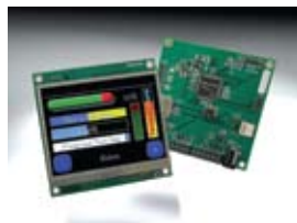
带以太网供电功能的 Stellaris 智能显示模块
