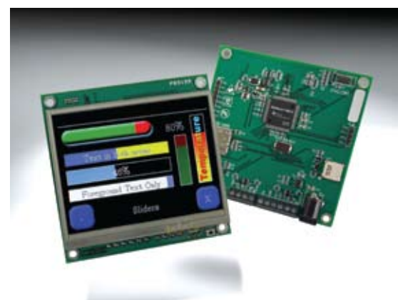
带 3.5 英寸横屏显示的 Stellaris 智能显示模块
