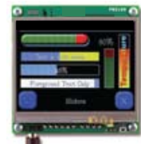
带 3.5 英寸横屏显示的 Stellaris 智能显示模块
