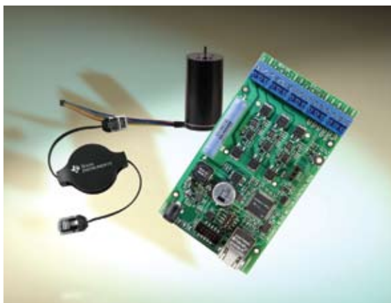
Stellaris 无刷直流电机参考设计套件
