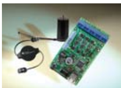
Stellaris 无刷 DC 电机参考 设计套件
