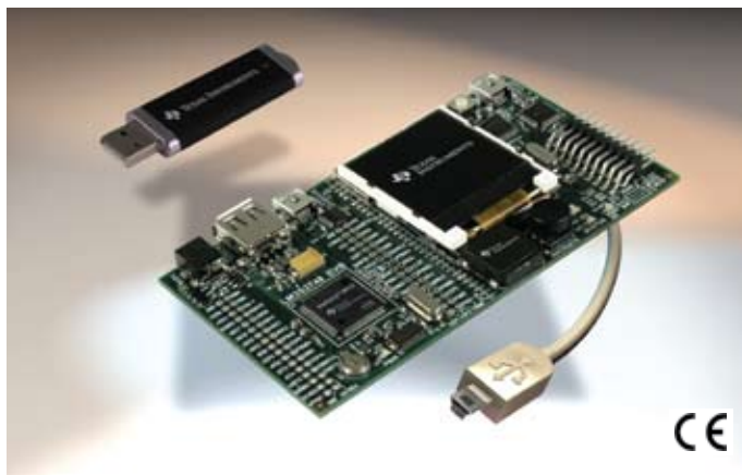
Stellaris LM3S3748 USB 主机 / 设备评估套件
