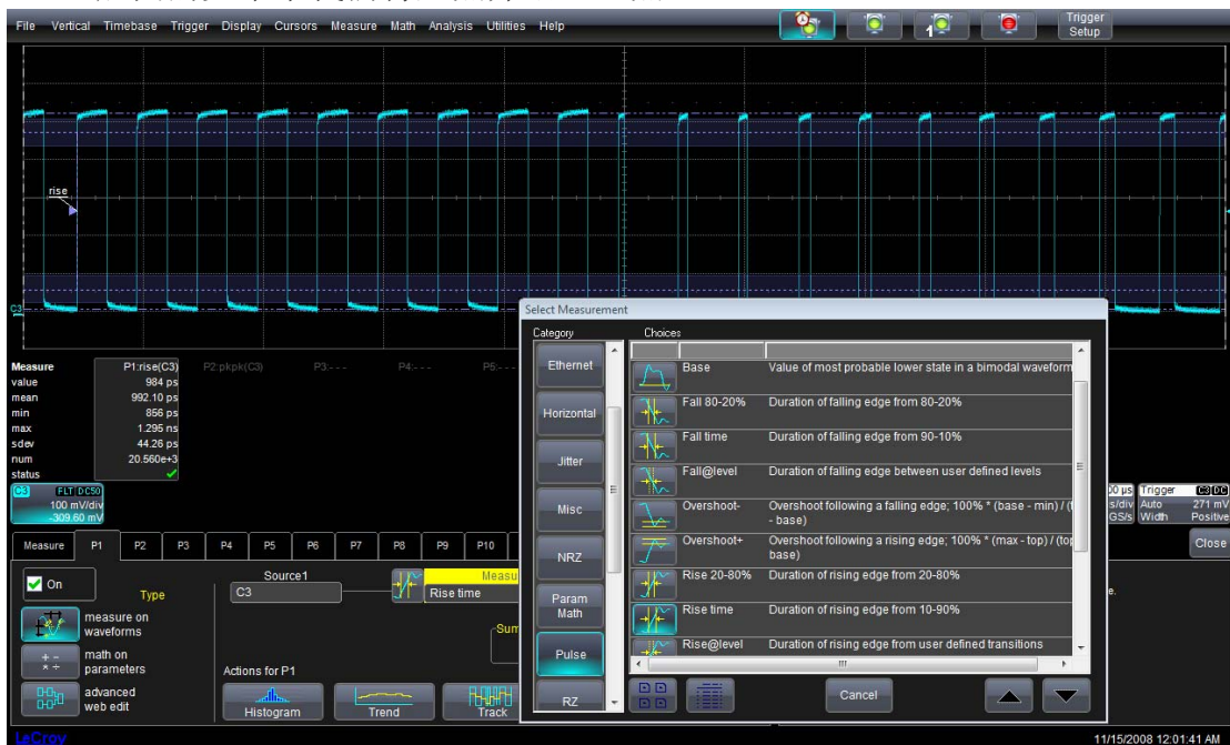
图四 参数列表中的直接说明了参数的含义，光标提供了该参数的形象说明
