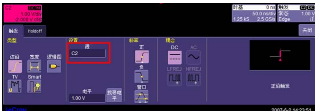
图三 触发设置界面——触发源
