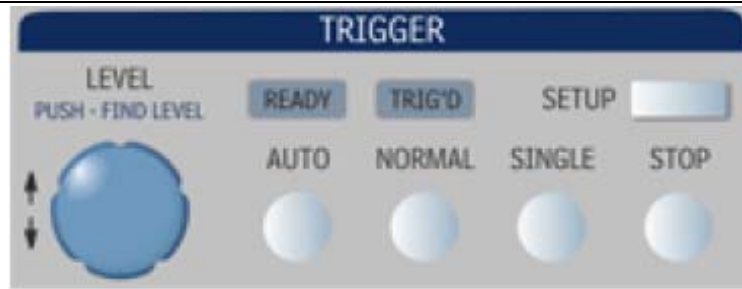
图五 示波器面板按钮的触发部分
