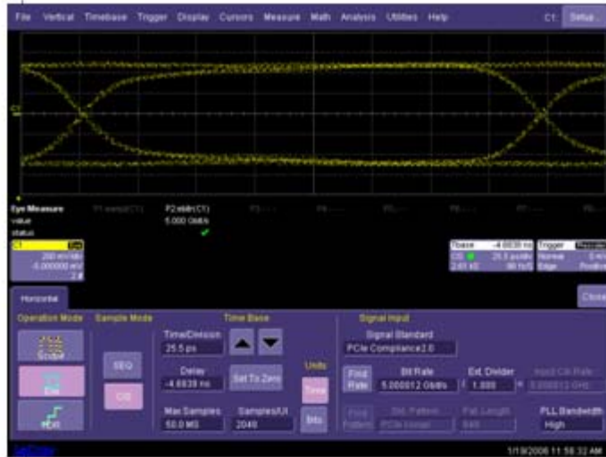
图9，用采样示波器测量5Gbps眼图
