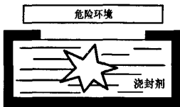
图5 浇封型原理示意图
