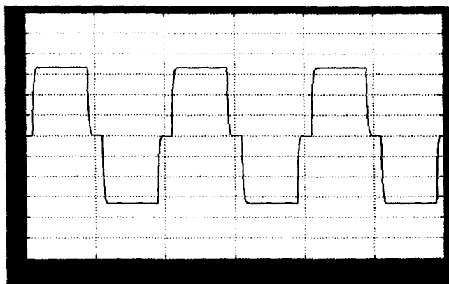
图9 经过高频滤波器后的主变换器输出电压波形
