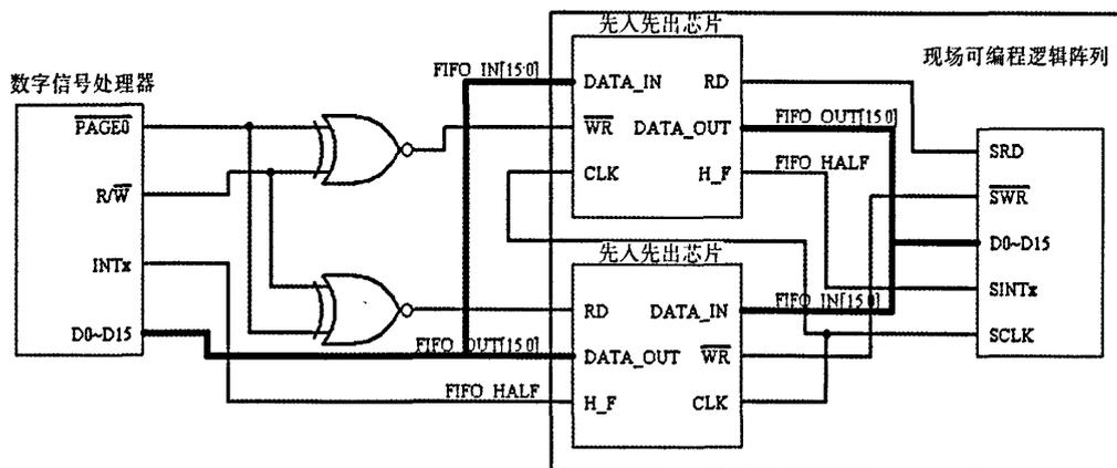
图 3 利用 FPGA 内部的 FIFO 数据缓冲器实现 FPGA 与 DSP 的接口
