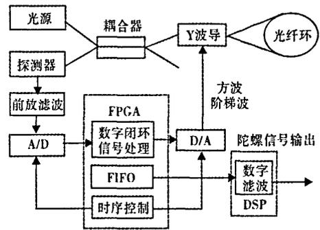
图 4 光纤陀螺信号处理和滤波电路的系统结构框图
