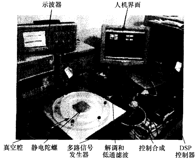
图5 静电悬浮转子微陀螺的试验系统
