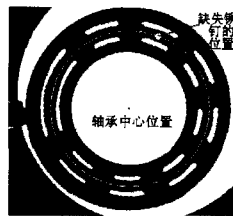
图8 铆钉漏装的判断
