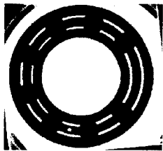
图6 阈值分割后的轴承图像
