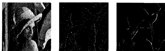
(a)加噪原图像 (b)Sobel 算子检测结果 (c)形态学算子检测结果
