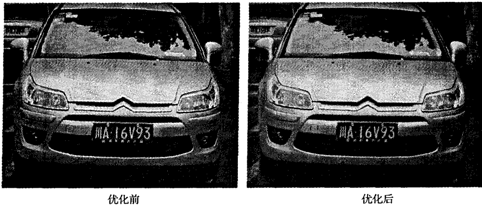
图 6 DCT 系数低通滤波优化前后图像质量对比
