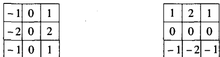
(a) 水平梯度方向,检测垂直边缘 (b) 垂直梯度方向,检测水平边缘
