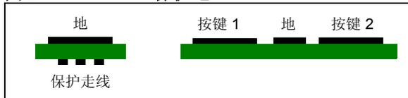
对于具有很强电磁干扰的应用，屏蔽连接到焊盘的走线可提高抗干扰能力。显然，按键界面不可能完全被地环绕包围，但如果屏内部可以屏蔽起来，则可保护而不受 EMI 干扰而产生相关的问题。
