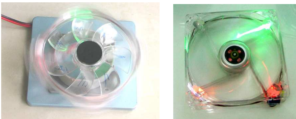
图 12、左侧：转子固定，定子旋转；右侧：定子固定，转子旋转
