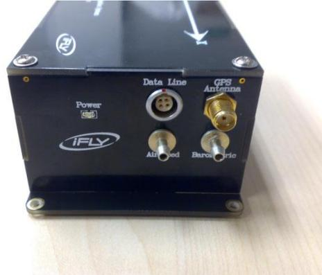
iFLY-G 是小型六自由度组合导航系统，提供 AHRS，GPS/INS，航位推算（航位推算仅限固定翼）三种组合导航模式。iFLY-G 包含三轴陀螺、三轴加速度计、三轴磁场计、GPS 模块、气压高度计、空速计和温度计，内部的 DSP 处理器提供实时的欧拉角、三维角速率、三维加速度、三维地磁场、三维位置、三维速度、前向气流速度和 UTC 时间等信息。
