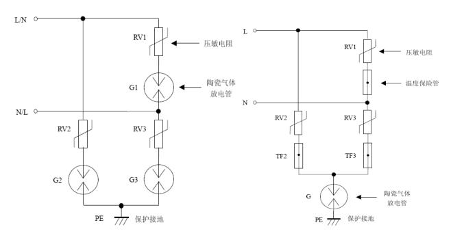
采用复合对称电路,共模、差模全保护,L、N可以随便接,正常工作时无漏电流。
