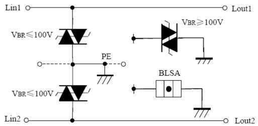
可用于信号频率/传输速率较低、线路中不能有连续直流电压、浪涌电流较小的场合 当接地线较长信号易受干扰时,加接击穿电压大于100V的TVS管或玻璃放电管再接地
