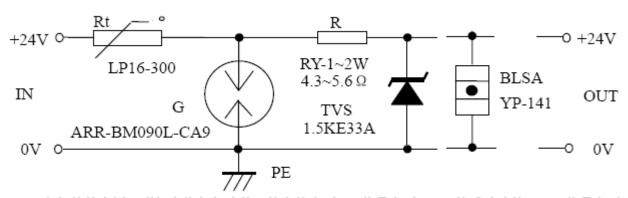
+24V负极接地电源,附加自恢复保险丝,放电管电压=2\*信号电压,TVS管或玻璃管=1.2\*信号电压
