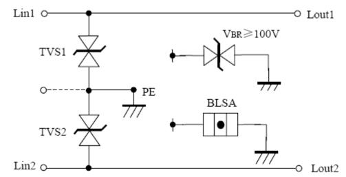
可用于信号频率/传输速率较低、线路中可能有连续直流电压、浪涌电流较小的场合 当接地线较长信号易受干扰时,加接击穿电压大于100V的TVS管或玻璃放电管再接地
