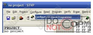
打开 STVP,选择 Configure -> Configure ST Visual Programmer。 第二步
