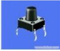
总共有四个引脚，一般情况下，处于同一边的两个引脚内部是连接在一起的，如何分辨两个引脚是否处在同一边呢？可以将按键翻转过来，处于同一边的两个引脚，有一条突起的线将他们连接一起，以标示它们俩是相连的。如果无法观察得到，用数字万用表的二极管挡位检测一下即可。搞清楚这点非常重要，对于我们画 PCB 的时候的封装很有益。
