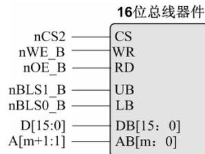
图 2.10 16 位总线器件连接示意图
