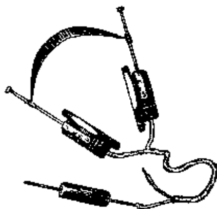
圖 402 用听筒串連電阻器來檢查
