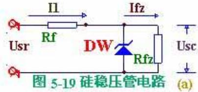
若  $U_{sr}$  不变而负载电流增加，则  $R_1$  上的压降增加，造成负载电压  $U_{sc}$  下降。 $U_{sc}$  只要下降一点点，稳压管中的电流就迅速减小，使  $R_1$  上的压降再减小下来，从而保持  $R_1$  上的压降基本不变，使负载电压  $U_{sc}$  得以稳定。
