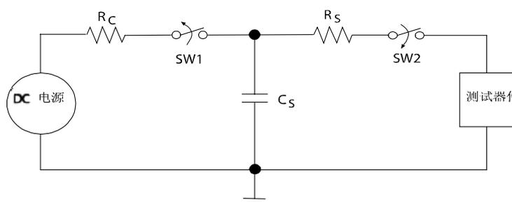
图 1-6 人体放电模式 ESD 测试电路
