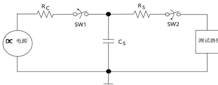
图 1-14 人体放电模式 ESD 测试电路
