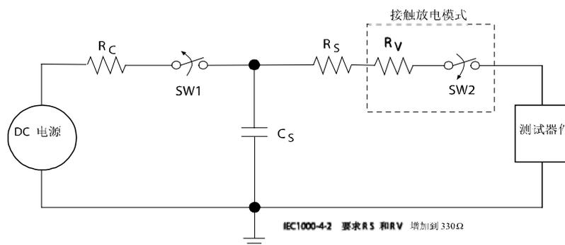
图 1-15 IEC1000-4-2 ESD 测试电路
