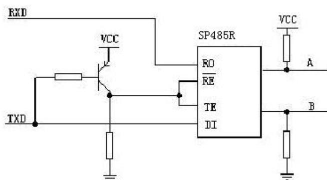
图 1-22 RS-485 接口电路的自动换向
