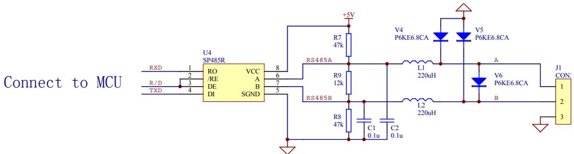
图 1-19 SP485R 的基本 RS-485 电路
