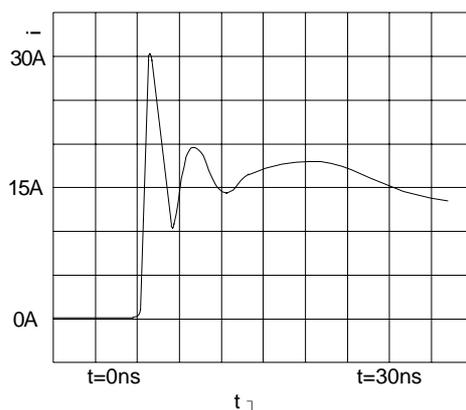
图 1-16 IEC1000-4-2 的 ESD 测试波形
