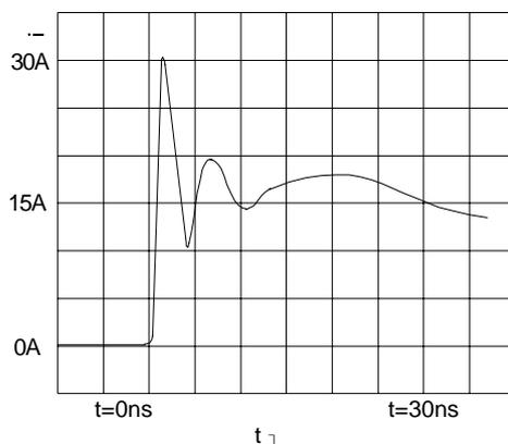
图 1-8 IEC1000-4-2 的 ESD 测试波形
