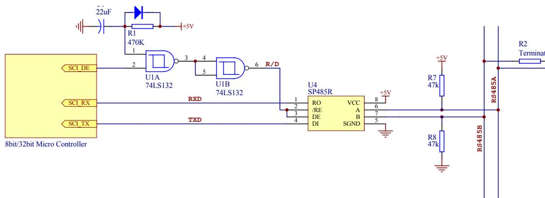
图 1-21 RS-485 接口电路的上电抑制
