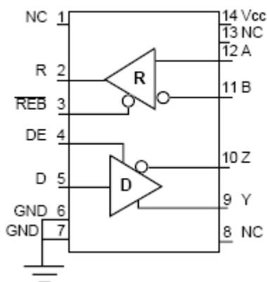
图 1-13 SP491E 的管脚配置
