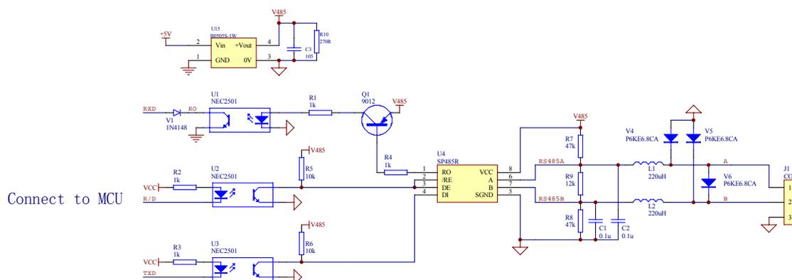
图 1-20 SP485R 的隔离 RS-485 电路
