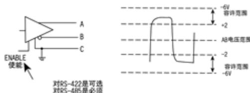
图 1-1 RS-485 发送器的示意图
