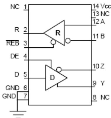
图 1-18 SP3491 的管脚配置
