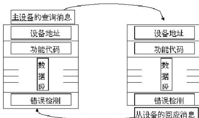
图 1-23 ModBus 协议的“查询—响应”模式
