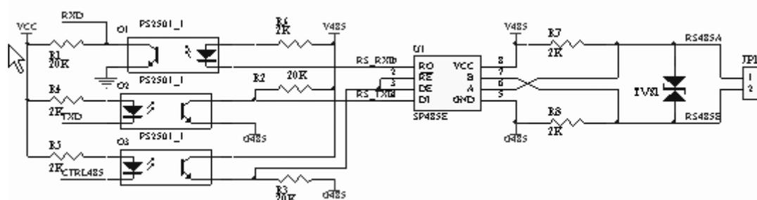
图 1-25 单片机与 RS-485 通讯转换电路图
