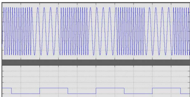
图 9-90 加入了 HIL 模块的 FSK 模型仿真波形图
