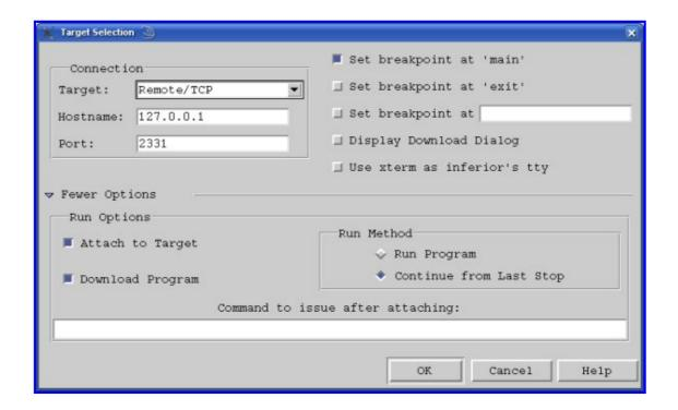
选择菜单File>Open,打开/home/lxz/at91rm9200/u-boot-1.2.0/u-boot这个映像;然后选择菜单Run>Download,将U-Boot程序下载到目标CPU。然后在程序运行的必经之路设定一个断点,如下图所示。
