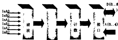
图 1 AB 相计数电路的组成框图
