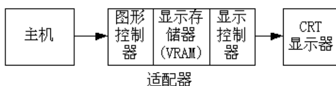
图 3-7 适配器、主机、显示器之间的关系图
