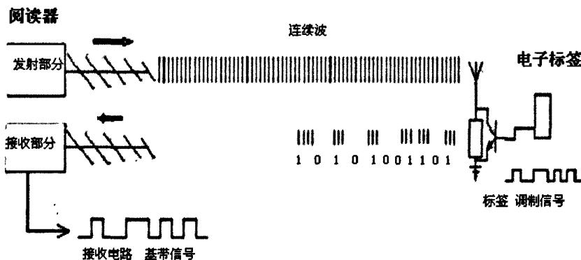
图 1 反射调制式 RFID 系统工作原理
