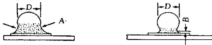
图 33 金属电极无引线端面元件焊点结构
