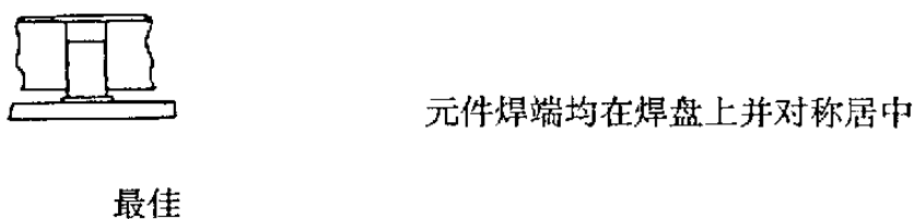
图 29 L形引线小外形集成电路位置精度
