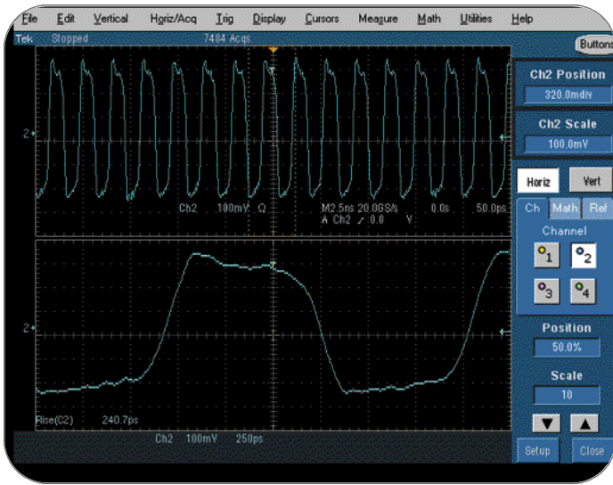
► 圖 30. 高速數位訊號的上升時間特性分析。
