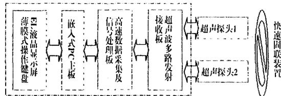
图2 超声波流量检测系统硬件结构框图
