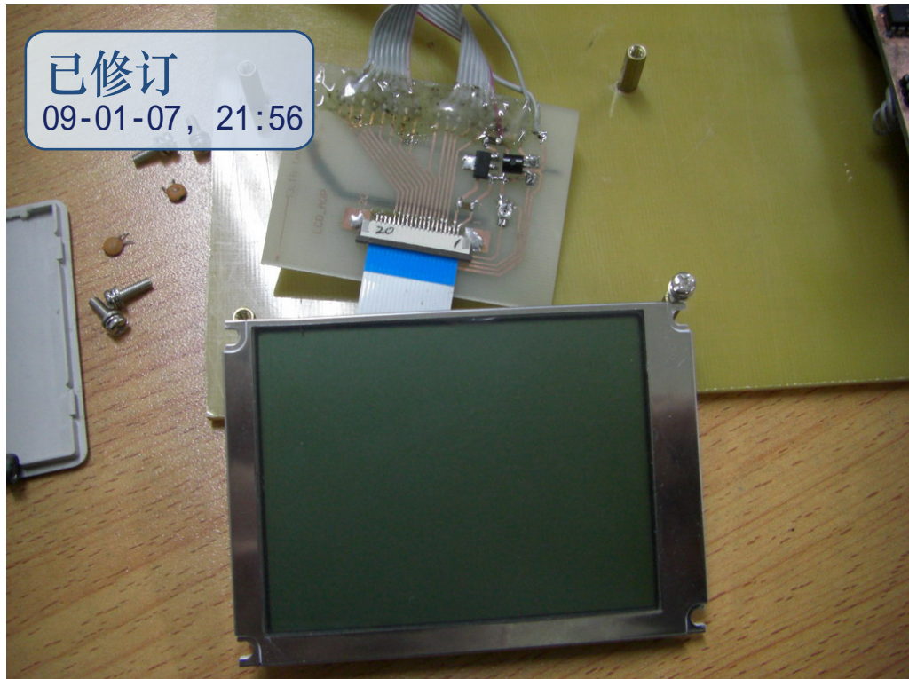
图 14: LCD 适配器与 LCD 连接照片
