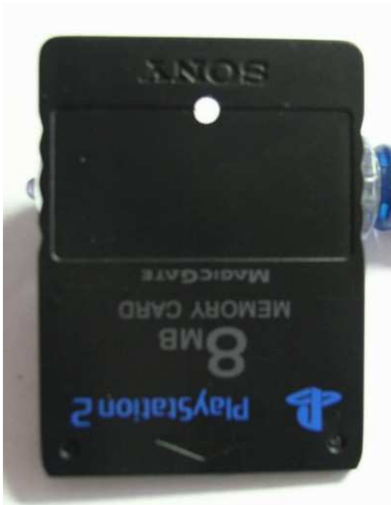
图 13 外壳上钻的孔
